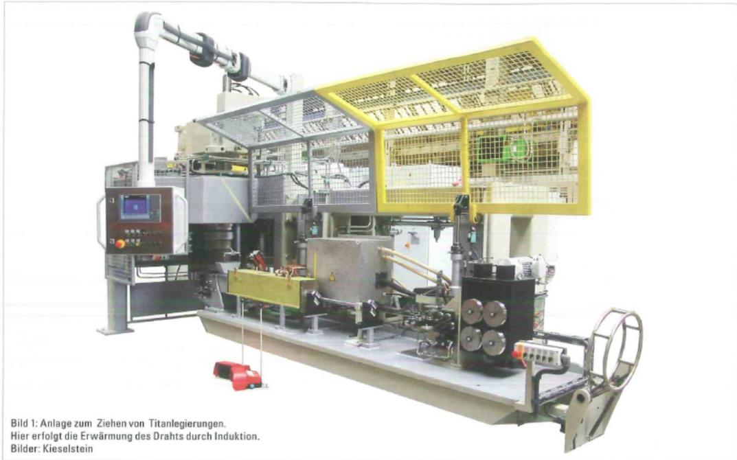
Bild 1: Anlage zum Ziehen von Titanlegierungen.
