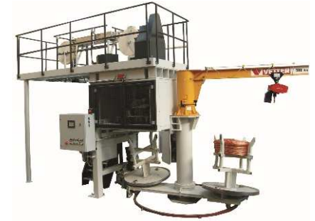
Vertikalwickler mit doppelter Drahtaufnahme
