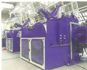
Bild 3: Anlage zum Ziehen und Ziehschälens von Gießdraht.
