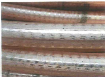
Bild 1: Detail Gießdraht, hier eine Kupfermagnesium-Legierung. Bilder: Kieselstein
