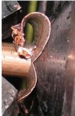
Bild 2: Spanabtrag durch Ziehschalen. Bilder: Kieselstein
